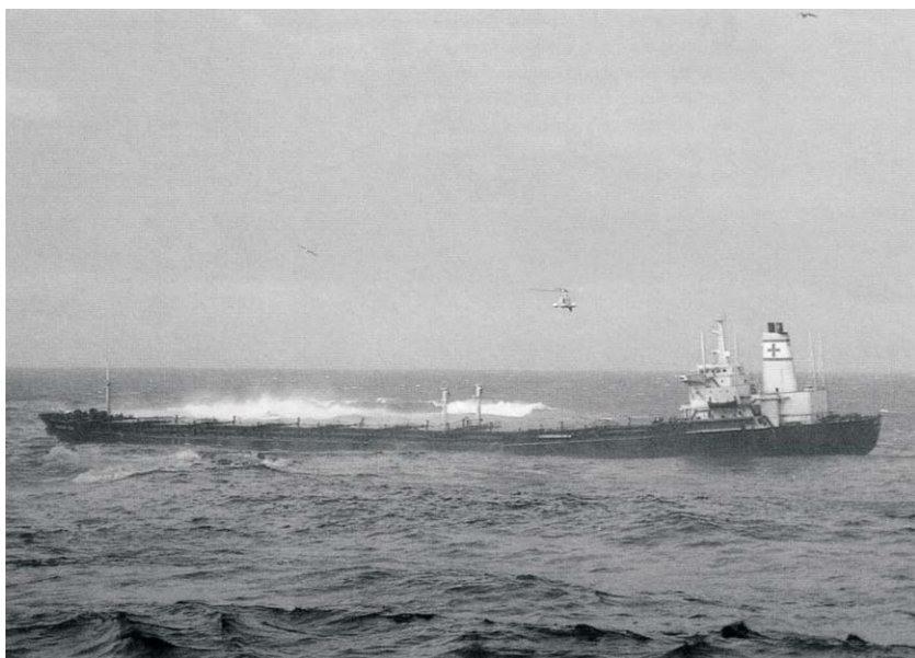
El "Aegean Sea" hacia las 0945; los tripulantes ya están siendo evacuados y puede observarse un helicóptero sobre la escotilla de la 8. Las rompientes que se aprecian por Er "balizan" las piedras del Buey (ver gráfico) y ya resulta apreciable que el buque se ha partido por la flotabilidad de su sección de popa. (Foto de G. Suárez publicada en la revista "Marina Civil")
