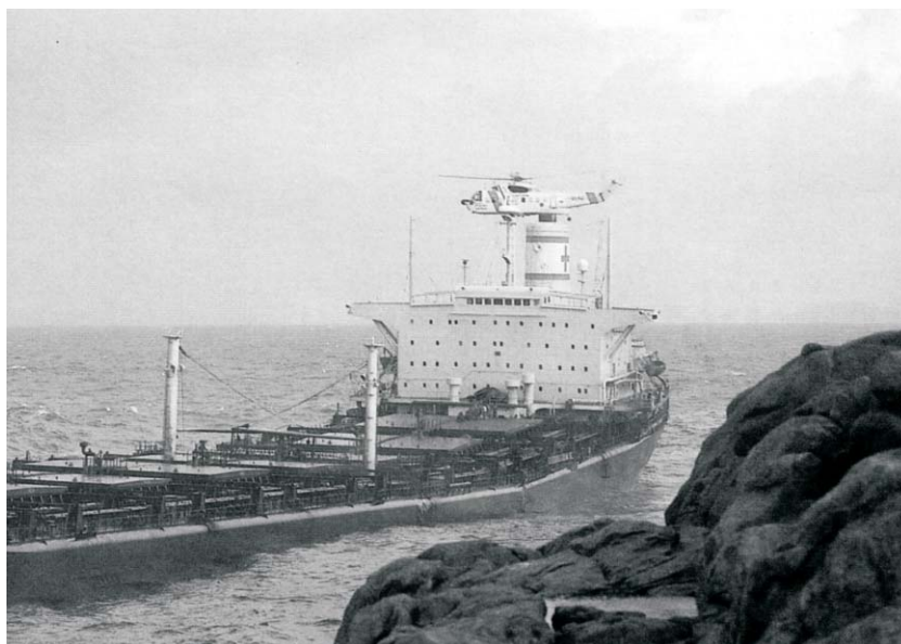
El “Aegean Sea” unos cinco minutos antes de hacer explosión; puede distinguirse al último grupo de tripulantes agrupados sobre la escotilla de la 9 mientras el helicóptero de la DGMM se dispone a efectuar una izada. El arrufo se ha agravado y son visibles dos líneas verticales de fractura a la altura de los puntales. (Foto de Oscar París publicada en la revista “ Marina Civil ”)
