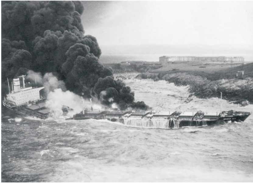
Con el casco definitivamente partido en dos, el cargamento del "Aegean Sea" comienza a arder en pompa. Apréciase la altura de las olas (unos 5 mts) por el seno existente en la bodega 3. (Foto tomada desde el helicóptero de la DGMM y publicada en la revista "Marina Civil")
