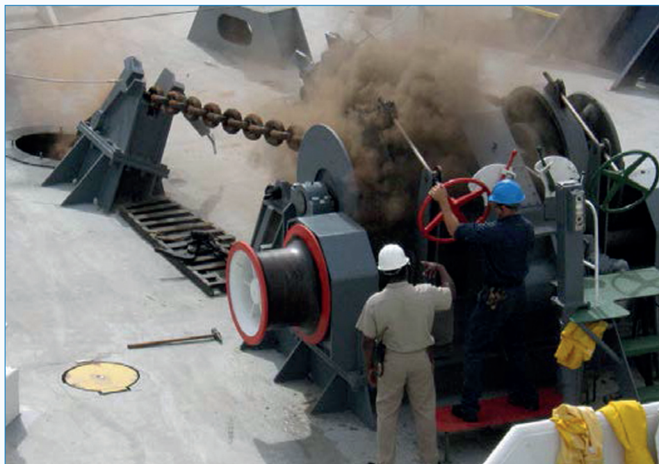
Fig. 7 – Arriado del ancla y cadena por gravedad.- Fuente: www.flickr.com/photos .
