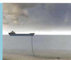
Fig. 34 – Fases del fondeo a la gira o en línea.-
