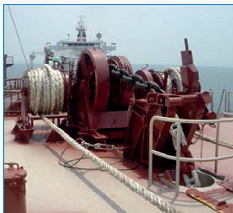
Fig. 4 – Diferentes vistas del molinete, barboten, escoben, sistema de limpieza de cadena.- Fuente: http://www.marinewiki.org & www.universoarancelario.com .
